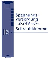
Schließen Sie die Spannungsversorgung von 12-24V AC/DC an der vorgesehenen Klemme mit dem mitgelieferten Stecker-Netzteil an. Die Polung spielt hierbei keine Rolle.
