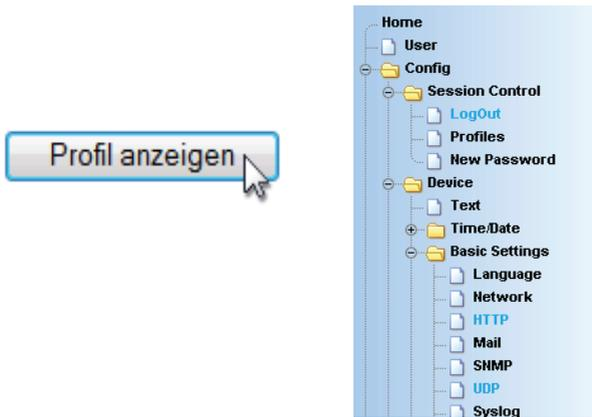
Neben TCP/IP Kommandos kann das Gerät ebenfalls UDP Datagramme beantworten. Hierzu muss der Port eingestellt werden, auf den das Gerät „hören“ soll. Die Voreinstellung ist 42279. Mit der Enable Funktion wird UDP eingeschaltet.
