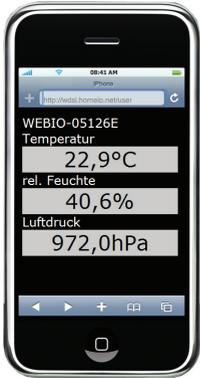
Um die Messwerte komfortabel auf Handys und Smartphones darstellen zu können, hat das Gerät eine vorkonfigurierte Web-Seite, welche an die speziellen Größenverhältnisse angepasst ist. Diese kann direkt über das Konfigurationsmenü über den Punkt „Smart“ aufgerufen werden.
